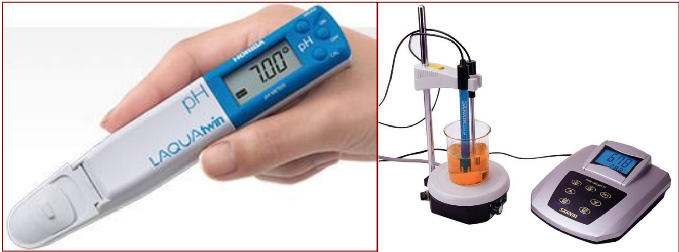
Figura 2. Izquierda. Equipo portátil para medición de pH del suelo. Derecha. Equipo común de laboratorio para determinar pH del suelo.
